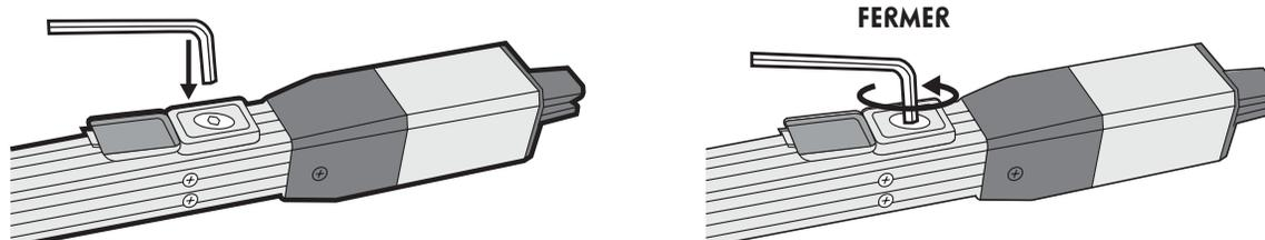
Manœuvrer chaque battant jusqu'à ce qu'il se bloque afin d'enclencher le système d'embrayage.
