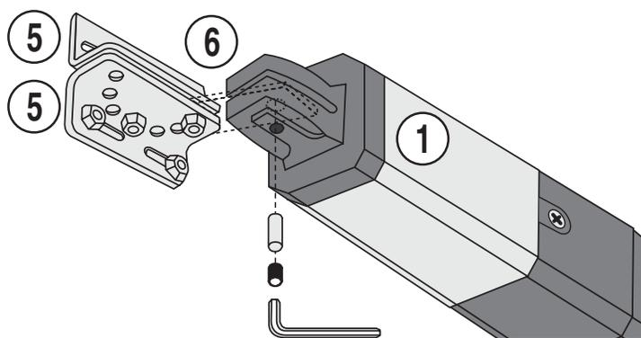
7- Assembler la patte en T avec le vérin. Attention le trou de fixation dépend du cas pour l'assemblage des équerres relevé dans le tableau page 11 (colonne "Trou de la patte en T").
