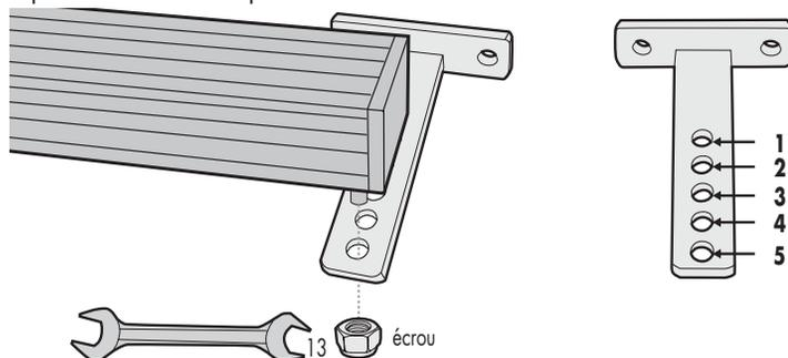
7- Ouvrir le portail à 90° puis faire pivoter le vérin afin de poser la base de la patte en T sur le portail. La base de la patte en T doit être sur le milieu de la partie rigide du portail afin que le vérin soit parfaitement horizontal.
