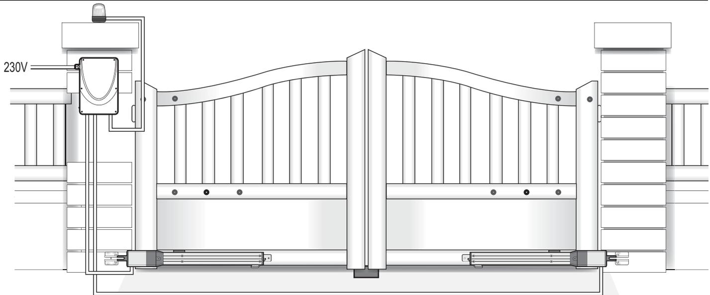
Le passage de ces câbles doit être conforme aux normes en vigueur (NFC 15-100).
