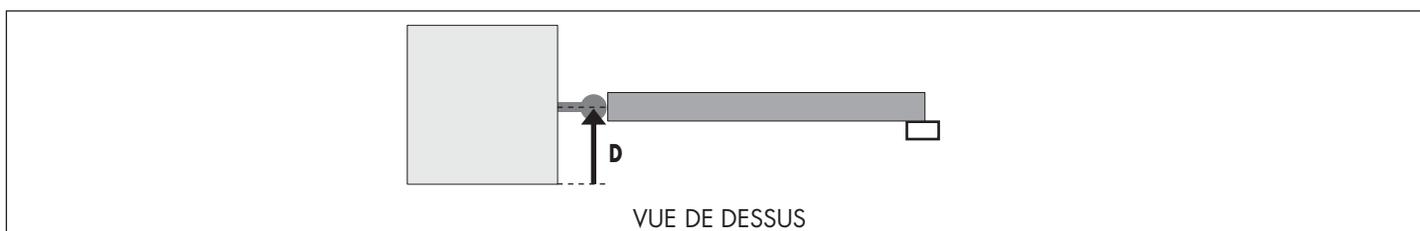
1- Mesurer la distance D de l'installation et à l'aide du tableau suivant, assembler les équerres et les pattes plates.
