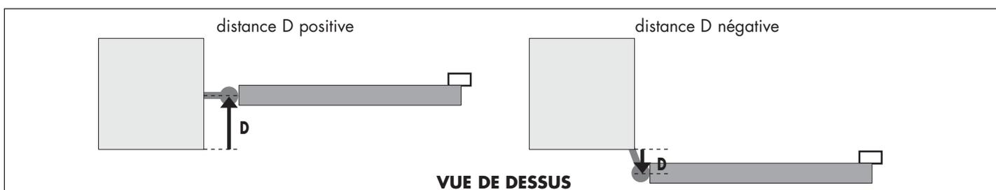
1- Déterminer l'angle d'ouverture de chaque battant en fonction des données du tableau suivant. L'angle d'ouverture peut être différent pour chaque battant mais ne doit jamais être inférieur à 40°.
