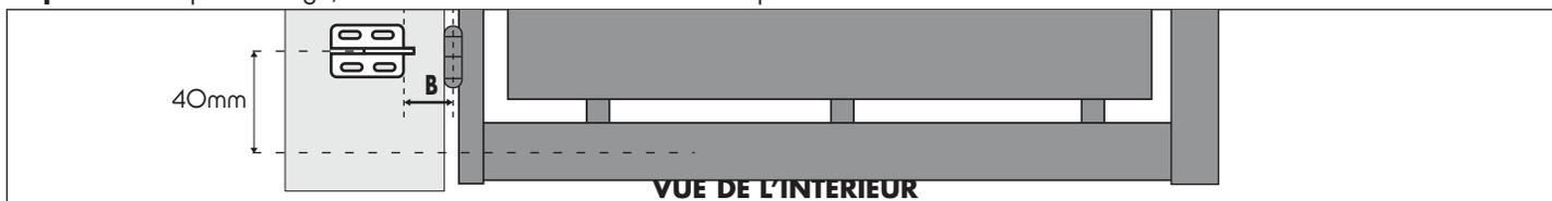
5- Retourner le vérin et s'assurer que la tige du chariot est à environ 10mm de l'extrémité opposée au moteur. Sinon, faire déplacer le chariot à l'aide d'une pile 9V 6LR61.
