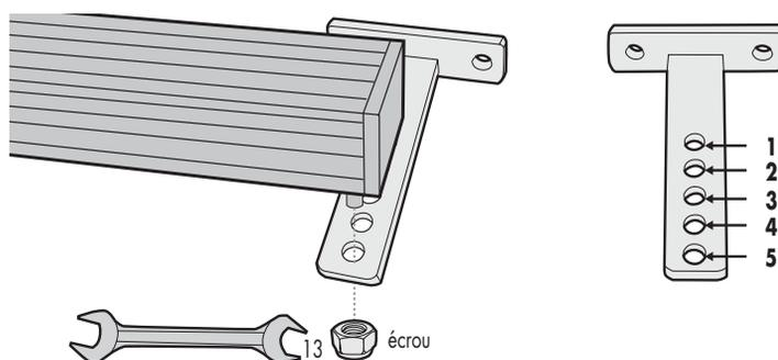
8- Fermer le portail en le plaquant bien sur sa butée centrale puis faire pivoter le vérin afin de poser la base de la patte en T sur le portail.
