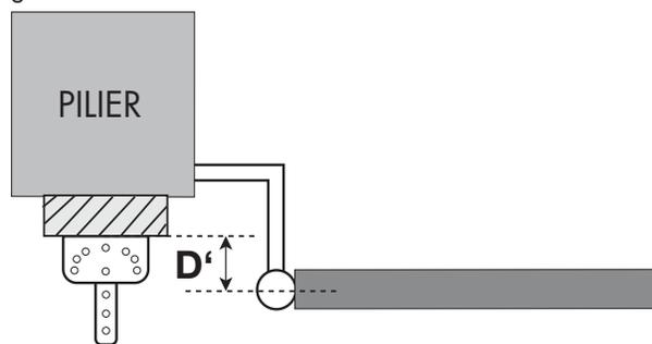
2- Tracer une ligne horizontale au milieu de la partie rigide du portail où sera fixé le vérin. Reporter ce trait sur le pilier et tracer un nouveau trait 40mm au dessus du trait préalablement tracé sur le pilier.
