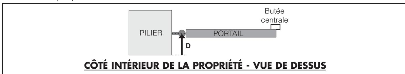
Déterminer l'angle d'ouverture de chaque battant en fonction des données du tableau suivant. L'angle d'ouverture peut être différent pour chaque battant mais ne doit jamais être inférieur à 40°.
